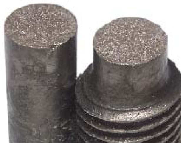
Krhki lom – nema plastične deformacije
