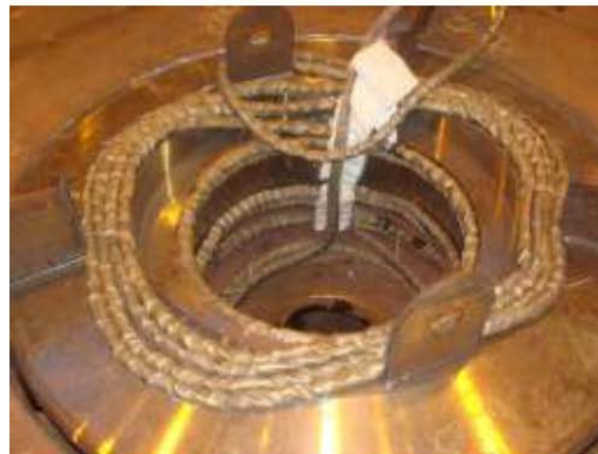
Predgrijavanje dijela sekcija broda – jaružara, Brodogradilište Uljanik d.d. Pula
