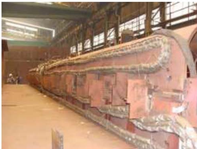
Predgrijavanje dijela sekcija broda – jaružara, Brodogradilište Uljanik d.d. Pula
